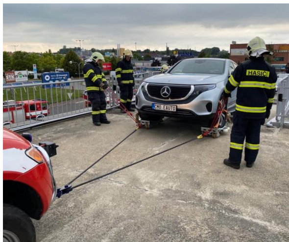
Obrázek 36 – Upevnění za tažná oka vozíků
