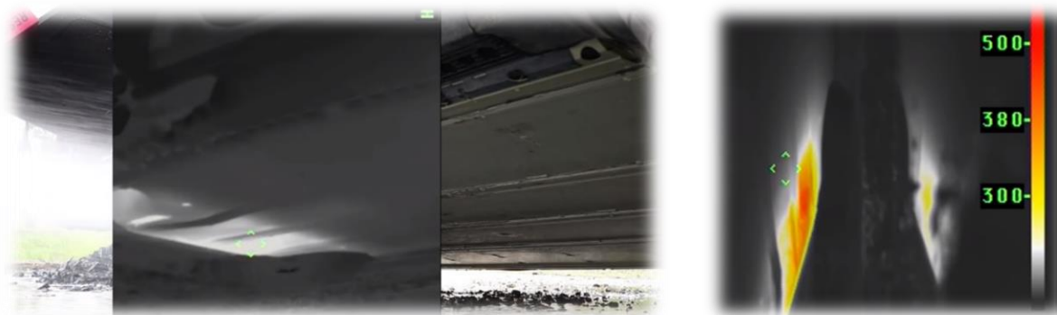
Obrázek 26 - Snímek zasažené sekce baterie termokamerou (6)
