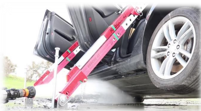
Obrázek 25 - Polohování vozidla při chlazení baterií (6)
