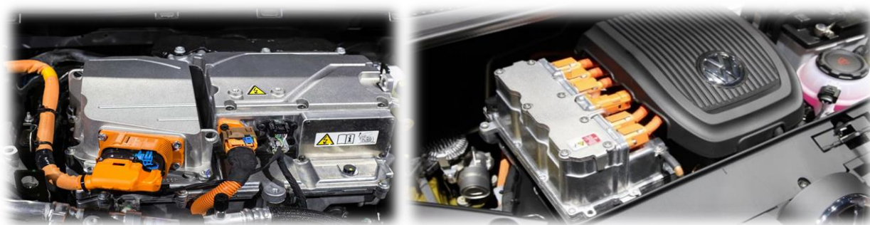
Obrázek 17 – „HV“ rozvody viditelné v motorovém prostoru
