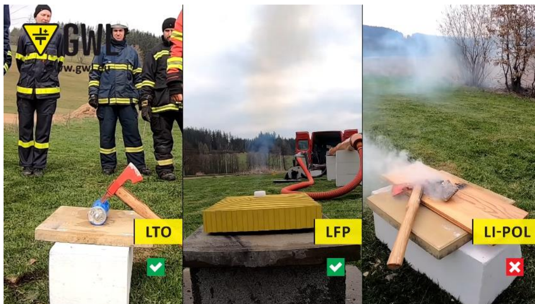
Obrázek 7 - Zkoušky mechanického poškození
