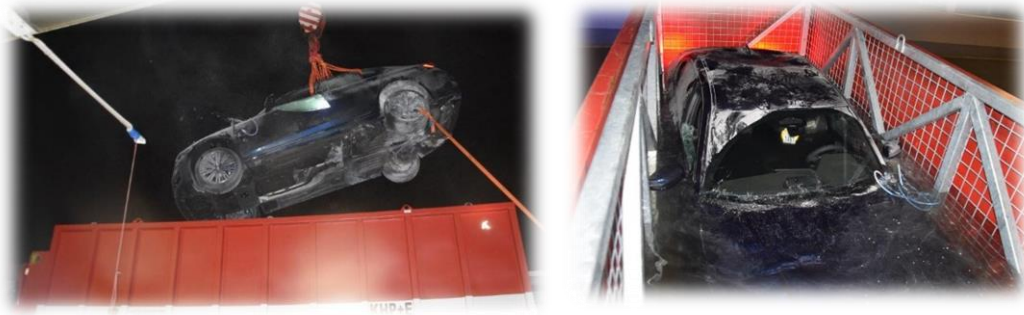
Obrázek 27 - Ponoření vozidla do kontejneru (8)
