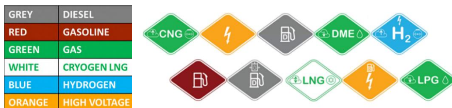
Obrázek 14 - Značky a související barvy pro identifikace paliva dle ISO 17840
