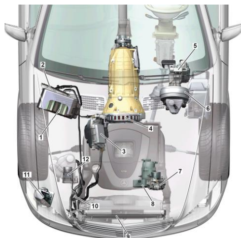
Obr. 85 – HV baterie je pod č. 1, [72, 101].
