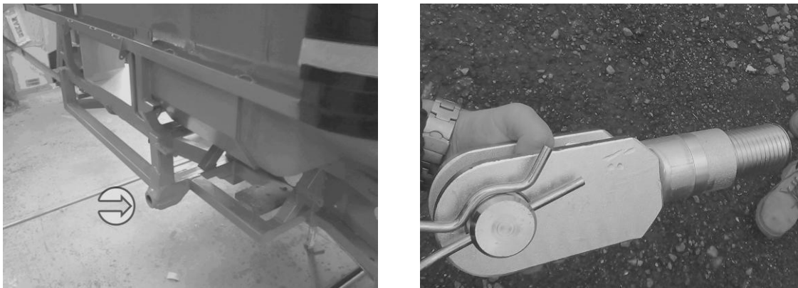
Obrázek 16: Přední vyprošťovací zařízení novějšího provedení. Na snímku vlevo je přední levý konec roštu podvozku, kam se zařízení montuje; vpravo oko zařízení
