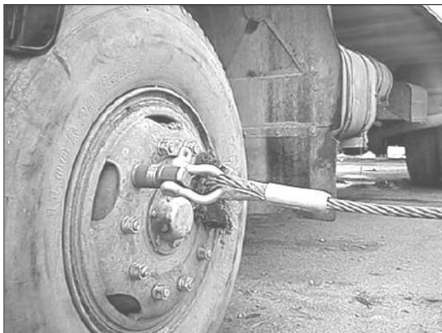
Obrázek 83: Zvedání autobusu za kola s použitím prodloužených matic kolových šroubů s okem 11
