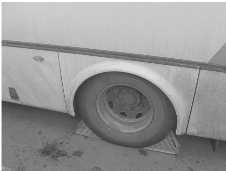
Obrázek 81: Zajištění autobusu proti pohybu oboustranným podložním klínů
