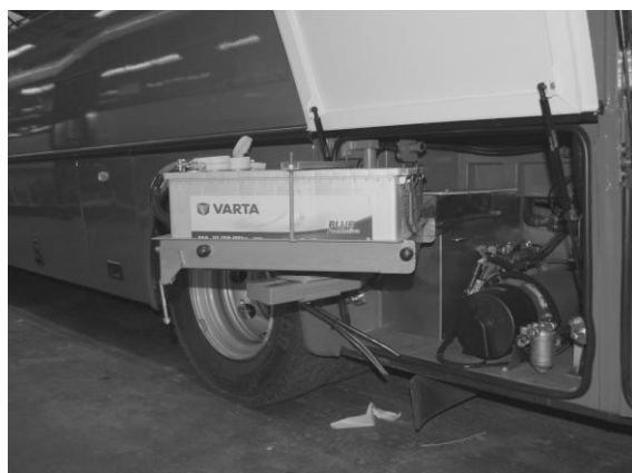
Obrázek 76: Vysouvání akumulátorů z předposlední schránky vpravo. Před vysouváním je třeba uvolnit dva zajišťovací háčky (šipky). Po vysunutí sání je možno je vytočit – obrázek vpravo
