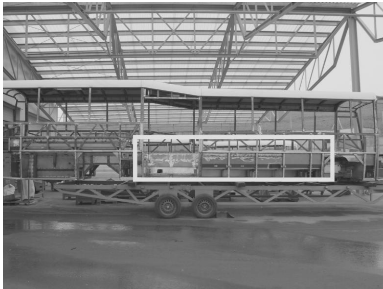
Obrázek 21: Zesílení bočnice nízkopodlažního vozu
