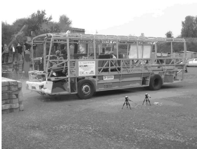
Obrázek 13: Vozidlo v konečné poloze po zkoušce (po odražení od bariéry)
