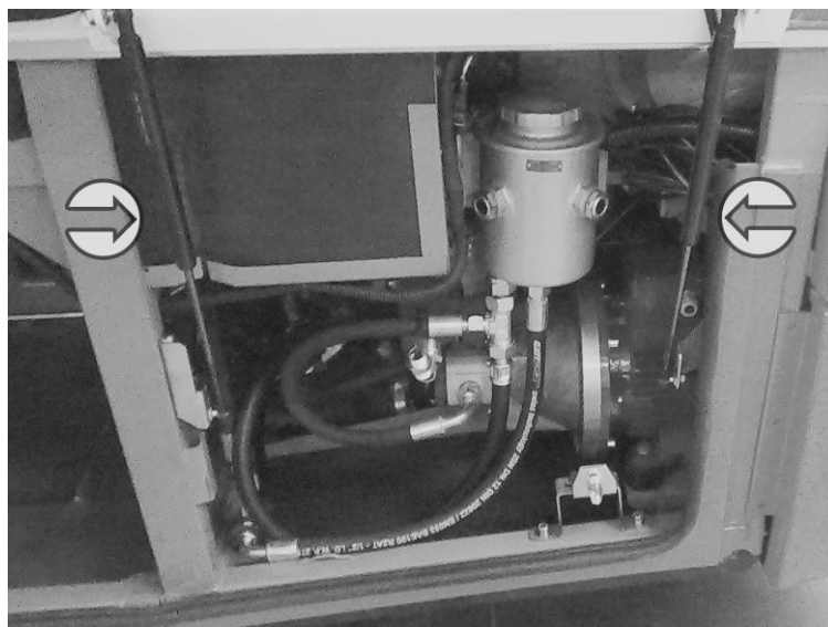
Obrázek 3: Víko schránky, které má na okrajích plynové vzpěry
