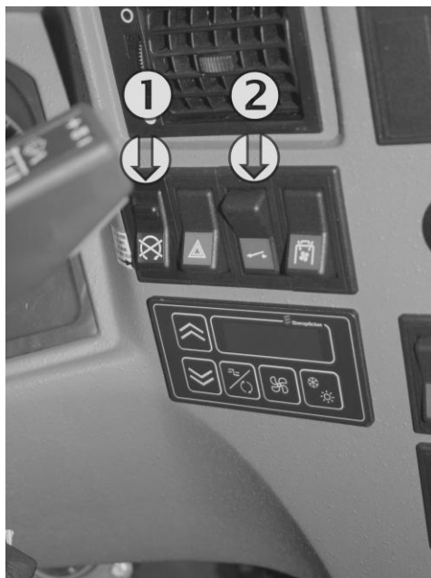
Obrázek 78: Spínače odpojovačů na palubní desce. Pozicí „1“ je označen nouzový spínač; pozicí „2“ normální spínač. Poloha spínačů je u různých vozidel různá; symboly jsou stejné
