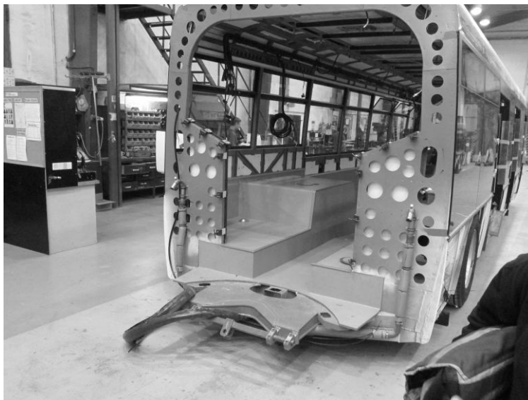
Obrázek 42: Přední část kloubového autobusu ve výrobě. Na snímku je dobře vidět přední část spojovacího kloubu a zesilující děrovaná přepážka. Na obrázku je také vidět vidlice, která slouží pro uložení ložisek, která dovolují vyklápění dílů vozu proti sobě kolem osy „Y“
