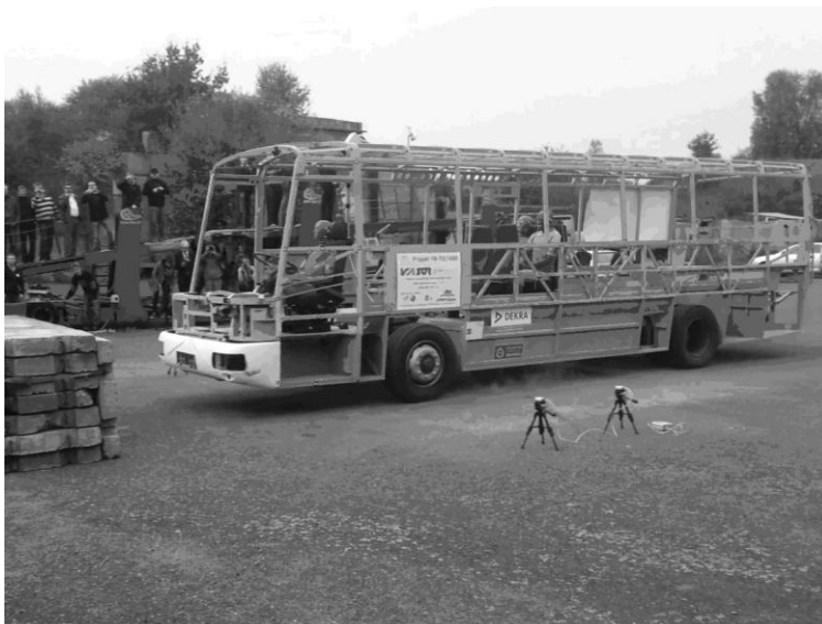
Obrázek 11: Kostra autobusu (snímek z bariérové zkoušky autobusu)
