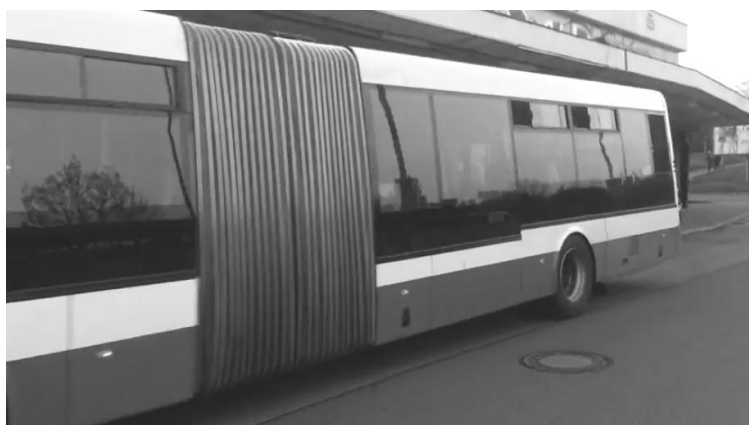
Obrázek 37: Pružný kryt spoje dílů kloubového autobusu – vnější pohled
