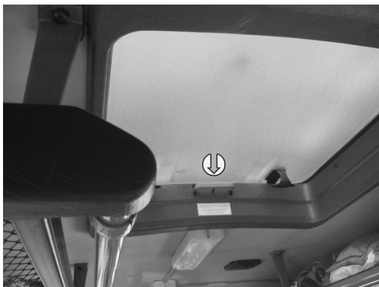
Obrázek 35: Střešní nouzový východ staršího provedení. Lze jej otevřít pouze zevnitř vozu zatažením za červenou páku
