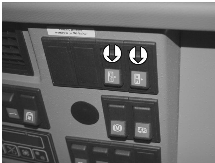
Obrázek 28: Spínače ovládání dveří na palubní desce
