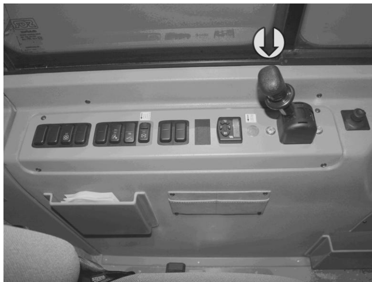
Obrázek 65: Levý pult pracoviště řidiče s ovládací pákou zajišťovací brzdy. Vůz je zabrzděný při zadní poloze ovládací páky (jako je na obrázku). Odbrzděn je při přední poloze. Na panelu jsou i spínače odpojovačů akumulátorů
