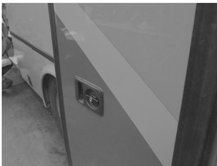
Obrázek 31: Mechanický zámek předních dveří
