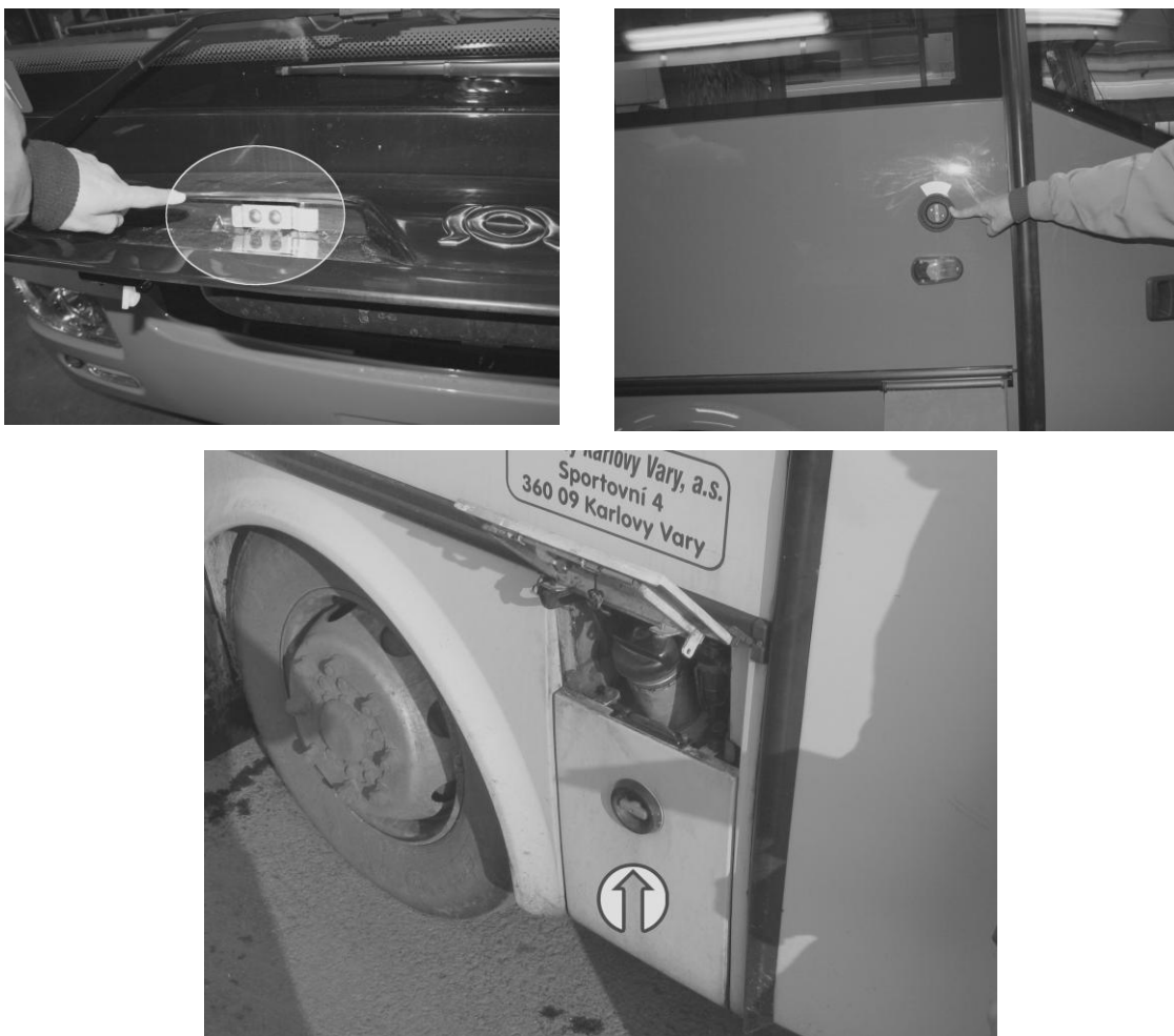
Obrázek 29: Ovladače nouzového otevírání dveří různého provedení autobusů
