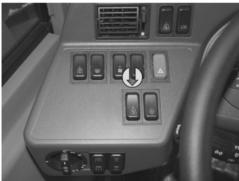
Obrázek 51: Spínač nezávislého (naftového) topení. Horní poloha – zapnuté oběhové čerpadlo, střední poloha – topení je vypnuto, spodní poloha oběhové čerpadlo i topení jsou v činnosti
