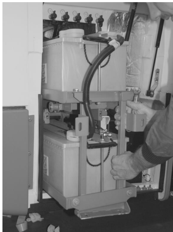
Obrázek 75: Vysouvání držáku s akumulátory u nízkopodlažního vozu
