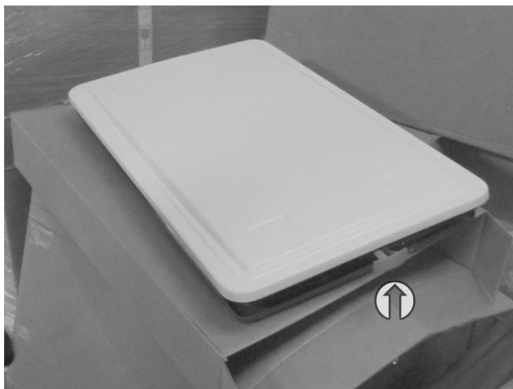
Obrázek 36: Kryt střešního nouzového východu novějšího provedení – před montáží na vozidlo. Zvenčí vozu jej lze otevřít po zatažení za červené ovládací táhlo
