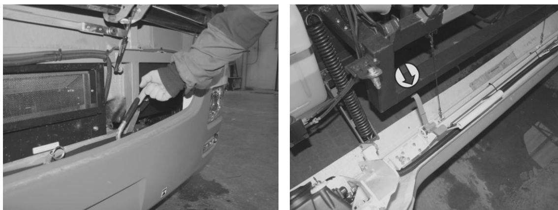
Obrázek 25: Otevírání předního víka pákou v jeho blízkosti. Vpravo zajišťovací háček
