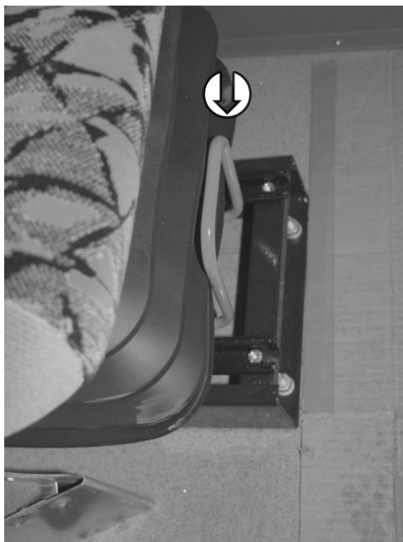
Obrázek 68: Rukojeť, která uvolňuje podélný posun sedadla
