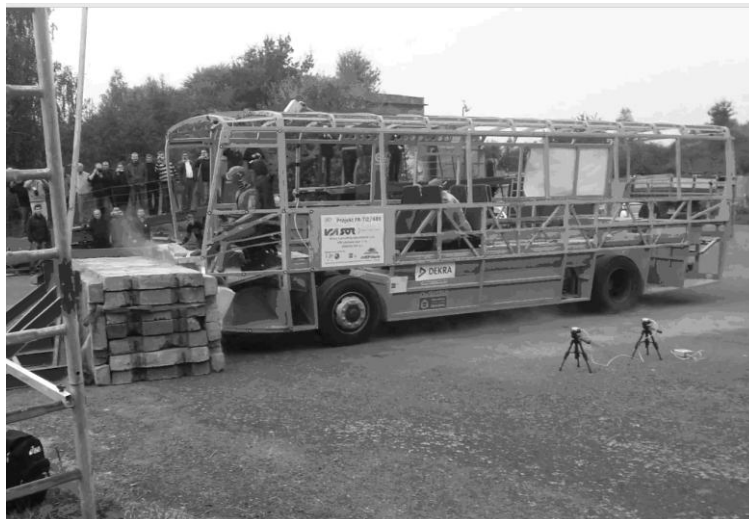
Obrázek 12: Bariérová zkouška – okamžik nárazu vozu do bariéry rychlostí kolem 25 km/h
