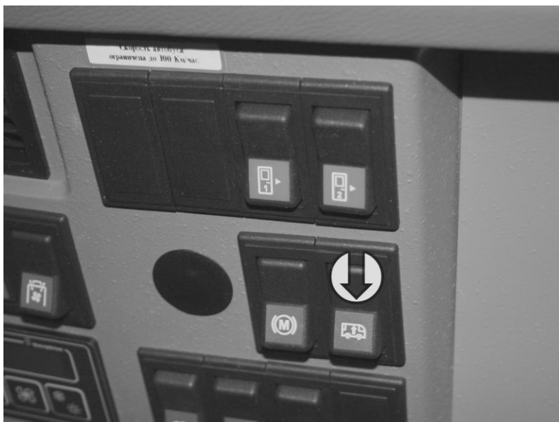
Obrázek 60: Ovladač jednorázového zvednutí vozu
