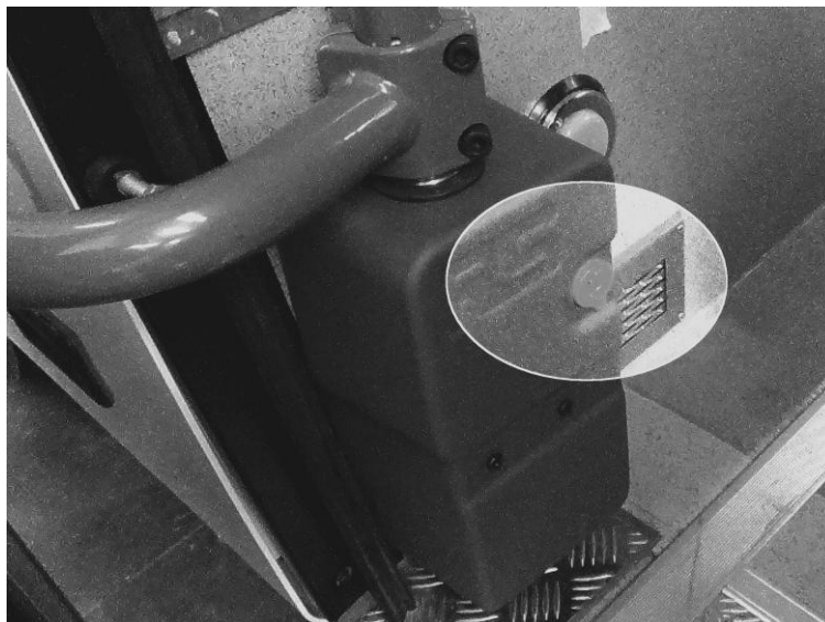
Obrázek 30: Mechanismus tlakovzdušného otevírání dveří
