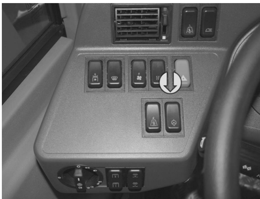
Obrázek 48: Ovladač vzduchotlakového blokování přestavování volantu. Vlevo standardní symbol na spínači; vpravo spínač
