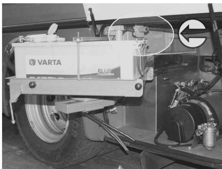
Obrázek 80: Mechanický odpojovač na stěně schránky akumulátorů, která je předposlední vlevo. Vlevo je svislá osa, kolem které se saně akumulátoru vytáčeji
