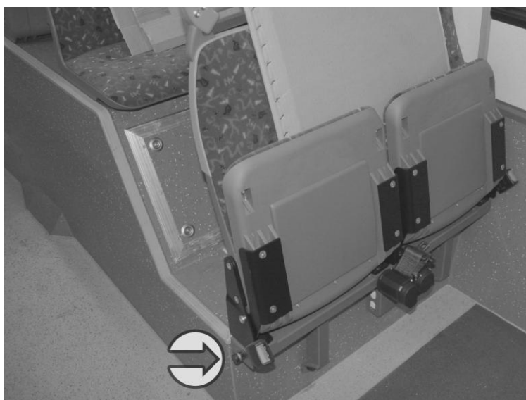
Obrázek 70: Sedadla cestujících v městském autobusu. Sedadla, před kterými není další sedadlo, jsou opatřena dvoubodovými bezpečnostními pásy bez navijáků
