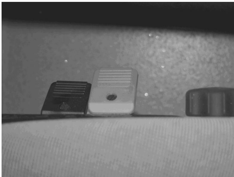
Obrázek 69: Ovládací prvky sedadla řidiče vozidla vyrobeného koncem roku 2013 umístěné na levé straně sedadla
