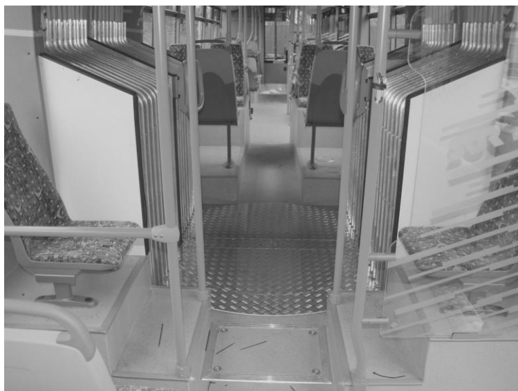
Obrázek 38: Vnitřek kloubového autobusu v prostoru kloubu. Na snímku je vidět jednak vnitřní kryt a dále pak kruhový kryt nad kloubem
