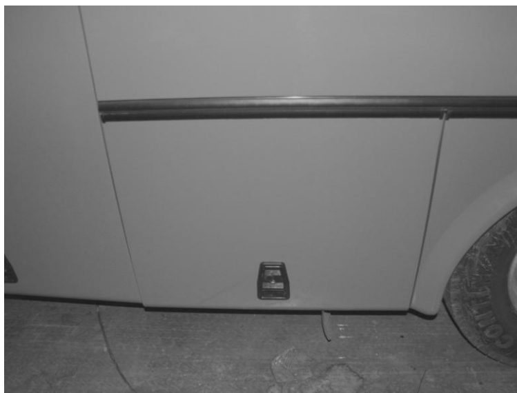
Obrázek 24: Víka schrán s příslušnými zámky
