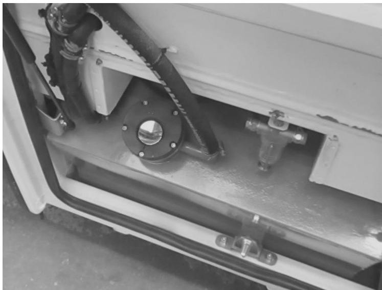
Obrázek 55: Detail víčka nádrže novějšího provedení. Víčko je pevně přišroubováno do hrdla, plnění se provádí odtlačáním odpruženého uzávěru, který je v jeho středu. V blízkosti víčka je čistič paliva „sklenička“
