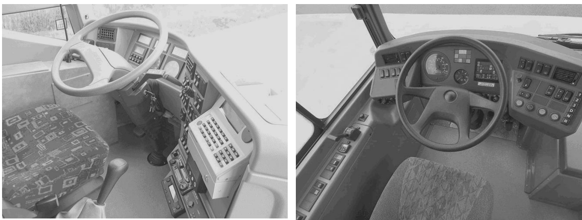
Obrázek 46: Pracoviště řidiče. Vlevo vozidlo s mechanicky řazenou převodovkou; vpravo s automatickou převodovkou
