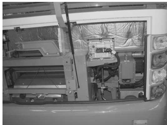
Obrázek 27: Isolační vrstva motorového prostoru. Vlevo před montáží do vozu; vpravo na mezistěně motorového prostoru
