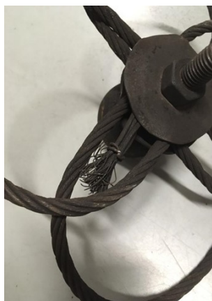
Obr. 7 a 8 Upravený kominický strojek pomocí ocelového lanka
