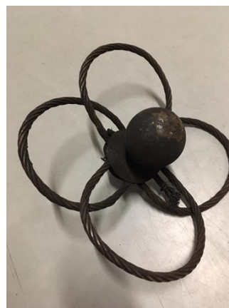
Obr. 7 a 8 Upravený kominický strojek pomocí ocelového lanka
