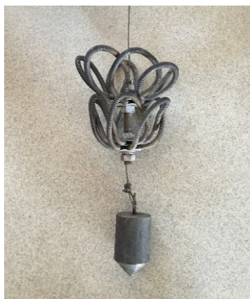
Obr. 6 Zdeformovaný kominický strojek
