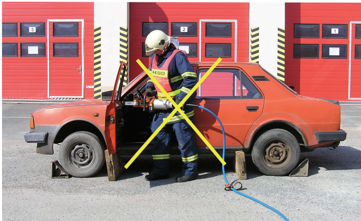
Obr. 17 Nesprávná práce s hydraulickým nástrojem
