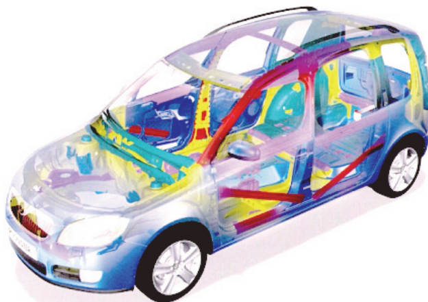
Obr. 29 Struktura karoserie s označením meze pevnosti kluzu R_{p0,2}
