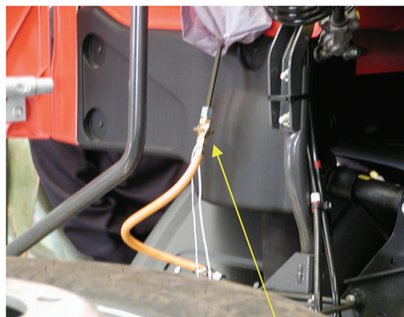
rozpojování přívodu plynu za kabinou
