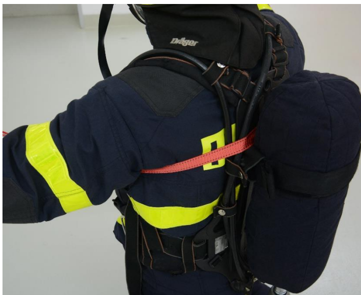
Obr. č. 3/3 Správné umístění víceúčel. pásu
