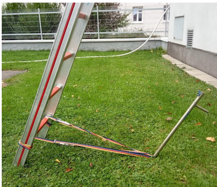
Obr. č. 3/6 Kotvení nastavovacího žebříku pomocí zemnicí tyče a pásu
