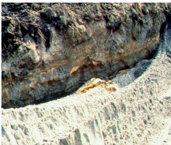
Obrázek 5, Ukázka skladby vrstev podloží [6]
