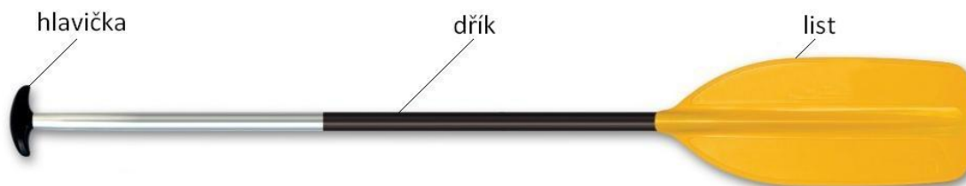
Obr. 5.1 Pádlo a jeho části
