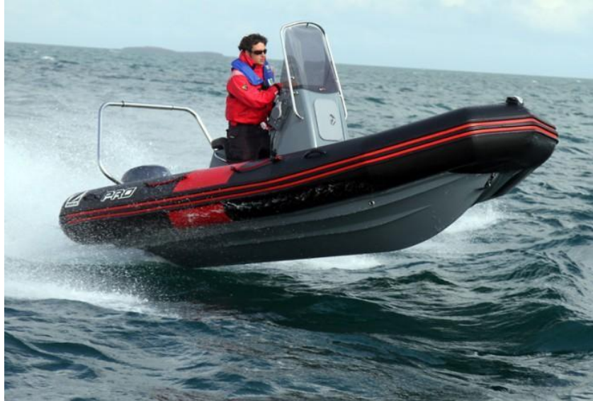
Obr. 7.19 Plavidlo smíšené konstrukce s laminátovým dnem
