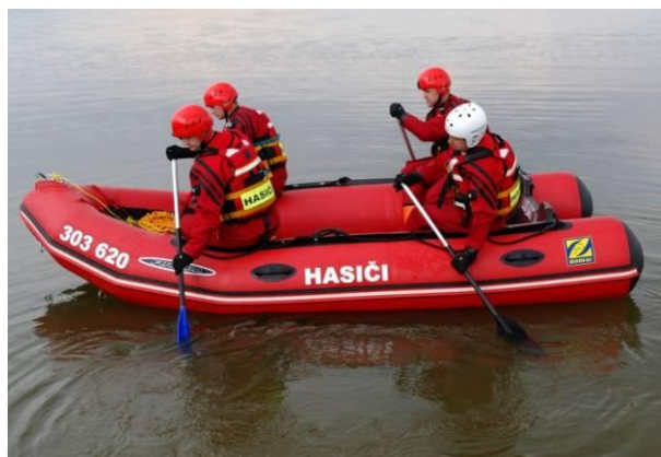
Obr. 7.18 Nafukovací plavidlo s pevnou zádí
