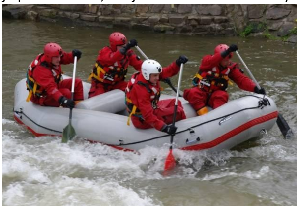
Obr. 7.17 Nafukovací plavidlo symetrické
