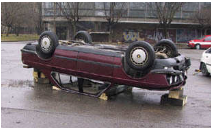
Obrázek 45 Příklad stabilizace vozidla na střeše [1]
