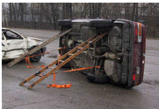
Obrázek 44 Příklad stabilizace vozidla na boku [1]
