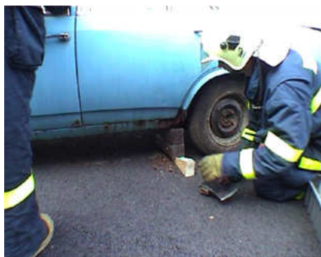
Obrázek 43 Stabilizace stojícího vozidla [1]
